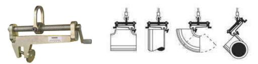
Fissaggio direttamente sul pezzo con carichi fino a 450 kg. Utilizzo per raccordi con inclinazione fino a 45°.
