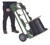
Carrello versatile, provvisto di base per trasporto delle bobine. 7 posizioni di alloggiamento per le aste di sostegno. 2 Guide per lo svolgimento filo delle bobine. 5 aste da Ø 16 mm, spostabili e removibili per il sostegno delle bobine.
