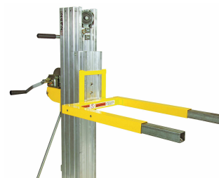
Prolunghe per forche. Possono essere allungate da 71 a 106 cm Il carico max di 90 kg viene indicato sulle forche, in base alla lunghezza raggiunta. cod. art. 9783691
