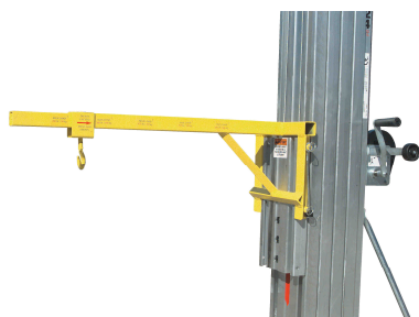
Barra con gancio a 5 posizioni per sollevamento con fune. capacità di carico: 300 – 240 – 195 – 135 – 90 kg cod. art. 9783642
