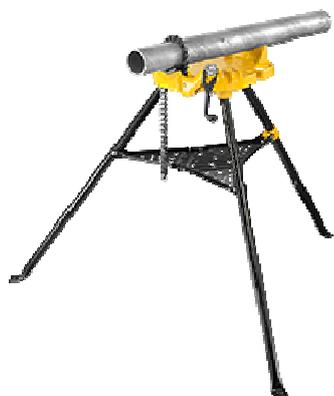
Cavalletto treppiedi pieghevole con piastra di appoggio per la lavorazione di tubi. Morsa a catena per tubi integrata con ganaschia doppia; diametro di serraggio  $\varnothing$  10 – 165 mm, ( $\varnothing$   $\frac{1}{2}$  – 6"). Con portautensili, 3 dispositivi di curvatura per piegare tubi;  $\varnothing$  10 – 26 mm, ( $\varnothing$   $\frac{3}{8}$  –  $\frac{1}{4}$ ").
